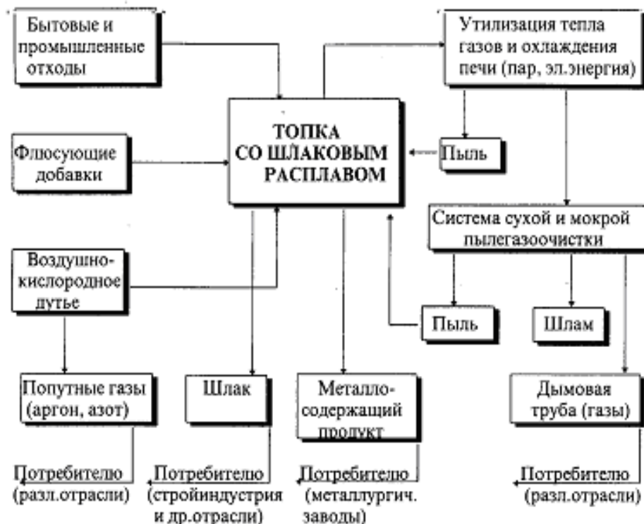
Рис. 15. Технологическая схема переработки отходов в расплаве шлака
